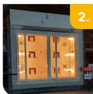
Brandversuch gestartet, Temperatur bis zu 800°C
