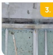
Beim Ansteigen der Temperatur wird der Brandschutzgel aktiviert. Rauchentwicklung möglich. Fenster widersteht dem Feuer für min. 30 min. TEST BESTANDEN
