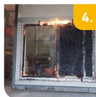
Nach Ablauf 30 min. wird Versuch weitergeführt, bis Scheibe zerspringt.
